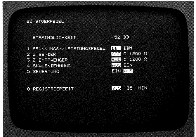
Bild 14/16 Parameter für Meßart 20 Störpegel
