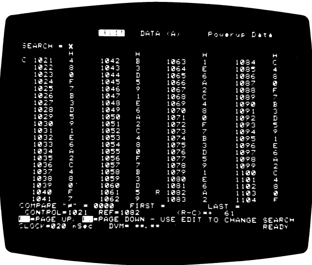
Bild 5/5 Datenanzeige in hexadezimalen Format für den Speicherbereich von 1021 bis 1104
