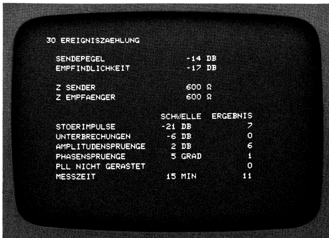
Bild 14/18 Meßergebnis bei Meßart 30
