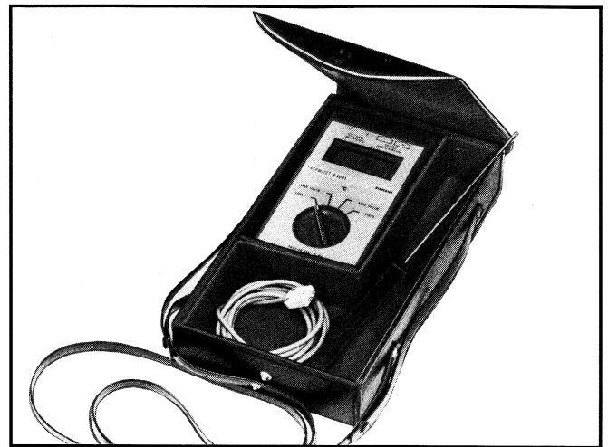
Bild 1/9 Bereitschaftstasche 7KB9401-8AQ mit THERMIZET B4001 und Oberflächen-Temperaturfühler, kurz
