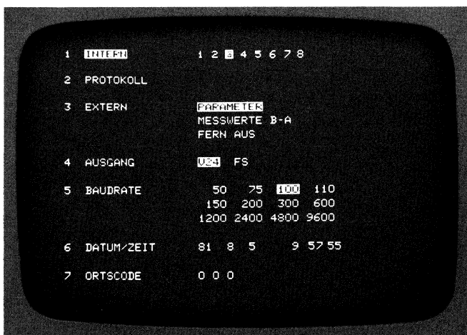
Bild 14/19 Parameter für Datentransfer
